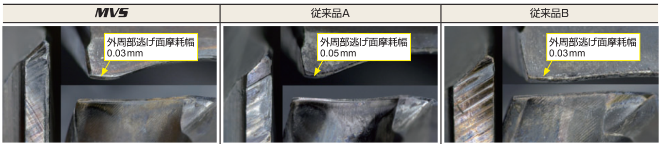
切削長55m加工時の刃先損傷状態
